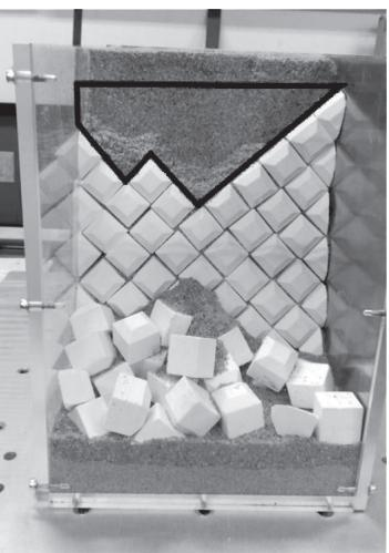
写真4 振動台実験のブロック崩壊
